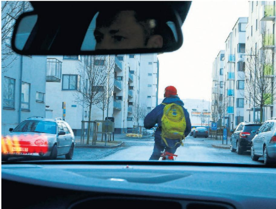
Notbremsassistent mit Radfahrerererkennung.
